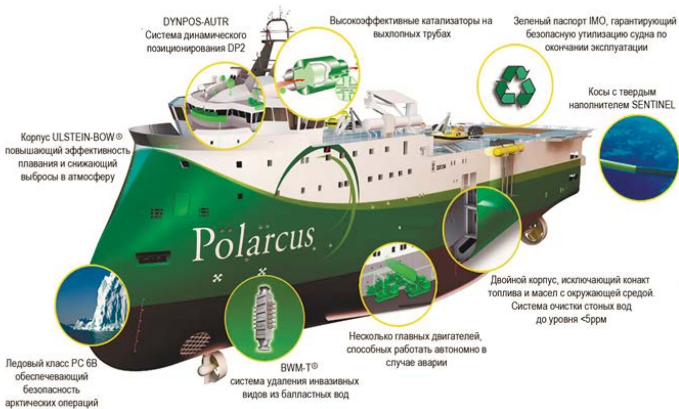
Рис. 2. Расположение основного оборудования на судах Polarus.
